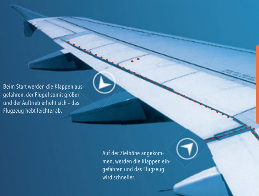
Beim Start werden die Klappen ausgefahren, der Flügel somit größer und der Auftrieb erhöht sich – das Flugzeug hebt leichter ab.
