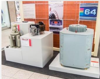
Heutzutage sind Festplatten der übliche Massenspeicher für Computer. Wir zeigen hier deren Entwicklung, angefangen mit Zuses 38-KByte-Trommelspeicher von 1958, der auch in der Z25 verwendet wurde, über einen Bryant-Trommelspeicher von 1964 mit 2,3 MByte und einen IBM-Plattenspeicher von 1984 mit 1,2 GByte bis zu einer Festplatte von 2004 mit 120 GByte: ein Verhältnis von ca. 1:60:3200:32000000!
