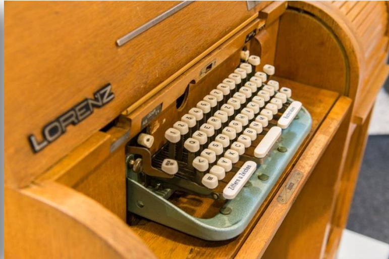
Bis in die 1970er Jahre hinein wurden Fernschreiber als Peripheriegeräte für Computer eingesetzt. Es waren bewährte und leicht verfügbare Geräte, die alles mitbringen, was ein kleines Computersystem als Peripherie braucht: eine Tastatur zur Eingabe, ein Druckwerk zur Ausgabe, einen Lochstreifen-Leser und -Stanzer zur externen Speicherung von Daten und Programmen und einen elektrischen Anschluss an das Fernschreibnetz, der genauso gut von einem Rechner angesteuert werden kann.
